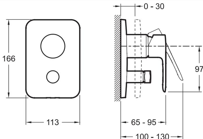
Спецификация продукта : Встраиваемый смеситель с переключателем на 2 выхода. E98714. Коллекция : JULY. РАЗМЕРЫ (CM) : 24.50 x 16.50 x 11.50 см. ВЕС : 2.6 кг. МАТЕРИАЛ : N/A. ТИП УСТАНОВКИ : Встраиваемые. TYPE D'ACCESSOIRE : 0. AVEC OU SANS ROBINETTERIE : 0. MITIGEUR : 0. FORME DE LA DOUCHE DE TÊTE : 0. INVERSEUR : Встраиваемый. TYPE DE FLEXIBLE : 0. Автоматический переключатель с функцией блокировки.
